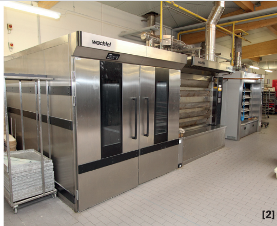
[1] Der Boden der Backstube besteht aus stabilen, rutschfesten Feinsteinzeugfliesen, die mit Rütteltechnik verlegt wurden. Im oberen Bereich des Bildes ist der Textilschlauch der kombinierten Heizungs-, Be- und Entlüftungsanlage zu sehen. Er sorgt für eine ruhige Luftbewegung in der Halle. [2] Das ausreichende Platzangebot vor der Ofen- und Gäranlage ermöglicht eine störungsfreie Ofenarbeit. [3] Auch die Teigmacherei ist übersichtlich und klar gegliedert.
