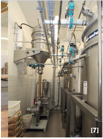
[7] Als überzeugter Bio-Bäcker mahlt beziehungsweise schrotet Roland Postler sein Getreide auf einer Steinmühle, die sich in einem separaten Raum im Lager befindet. [8] Sämtliche Stromleitungen im Produktionsbereich sind in offenen Trassen verlegt. Sie bieten daher Schädlingen keinen Unterschlupf und sind leicht zu reinigen.
